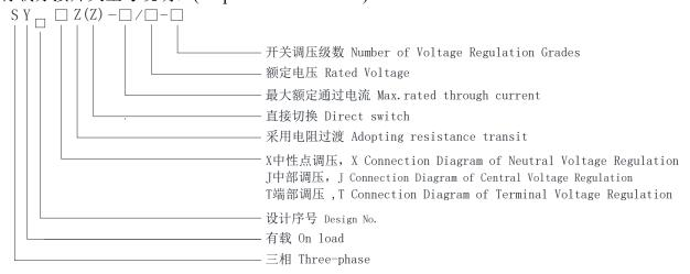
例如: SYJZZ 200/35-9 表示三相有载中部调压采用电阻式过渡电阻直接切换的有载开关,开关额定电流为200A,额定电压35KV,开关有9档分接。
