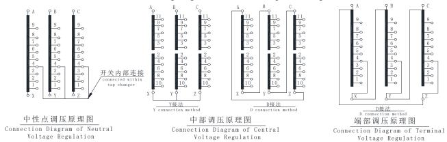
3.3 本开关是一种复合式的电阻过渡的埋入式有载分接开关,开关有隔离于变压器的单独油室利用变压器油作绝缘和灭弧介质,因此结构简单,体积较紧凑,也便于用户检修和换油。开关的安装法兰上面,即露出变压器油箱平面的那一部分,是机械传动部分,由单相电机带动二级蜗轮蜗杆做减速传动,由上隔板下面的弓形板推动主弹簧拉伸储能,利用弹簧"过死点"后释放的能量推动拨槽件由拨槽件推动槽轮,作传动一定角度的运动,完成开关的操作任务。在动触头支架的主动触头和辅助触头之间,由过渡电阻作切换过程中的限流作用,开关的动静触头上均镶嵌铜钨合金,使开关的电气寿命足以能完成所规定的技术指标。
